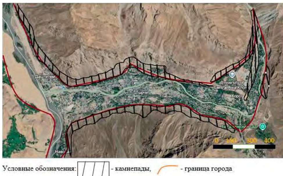
Рисунок 1. Карта-схема распространения камнепадов на территории города Хорог по данным дистанционного зондирования
